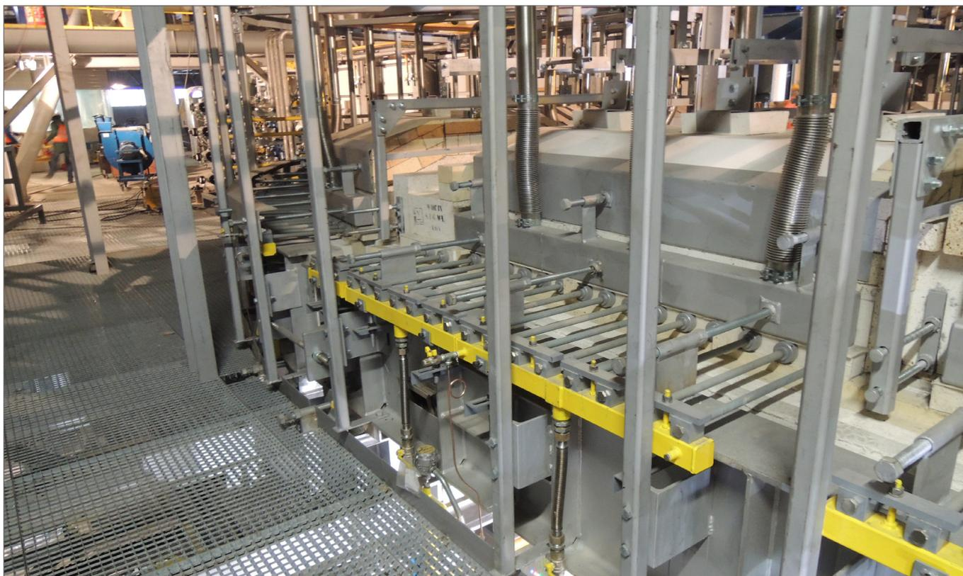
**Glass Service** разработал технологию горелок для фидеров и распределительных канлов вместе с необходимыми коллекторами и креплениями для обвязки канала питателя.
